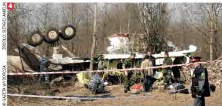
Miejsce katastrofy. Ułożenie podwozia potwierdza hipotezę o obrocie spadającego samolotu o 180 stopni
