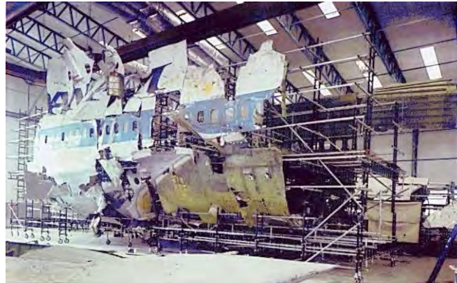
Tak wygladala rekonstrukcja kadluba Pan Am Flight 103 Lockerbie, 1988
