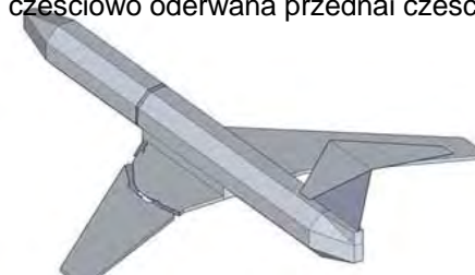
(3) Przednia część kadłuba zachowuje swoją pionową płaszczyznę, a tylna wraz ze skrzydłem obraca się wokół osi podłużnej
