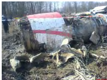
To jest tzw. kierownica – pierwszy stopień sprężarki (łopatki nieruchome)
