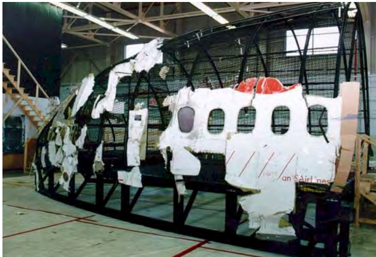
Rekonstrukcja SR Flight 111, katastrofa McDonnell Douglas MD-11, 02 09 1998
