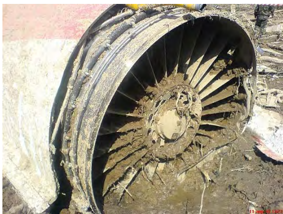
To jest tzw. kierownica – pierwszy stopień sprężarki (łopatki nieruchome)
